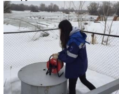
Рис. 2.4 – а) Устройство дрены б) Замеры уровней воды и углеводородов в скважине
